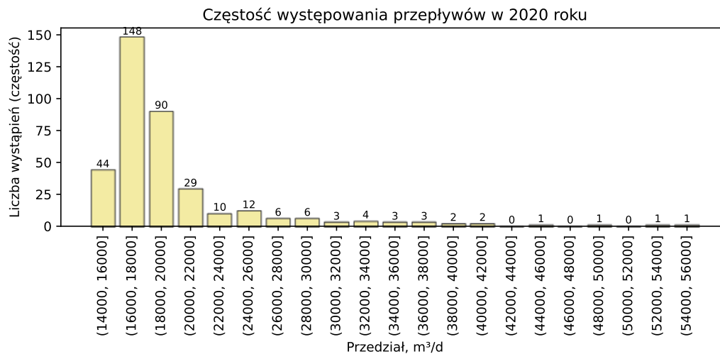
Rysunek 12. Częstości wystąpień przepływu dobowego ( Q_d , m³/d) wyrażone jako liczba pomiarów w danym przedziale wartości w roku 2020.
