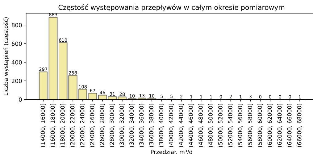
Rysunek 9. Częstości wystąpień przepływu dobowego ( Q_d , m 3 /d) wyrażone jako liczba pomiarów w danym przedziale wartości w okresie od 01-01-2018 do 10-07-2023.
